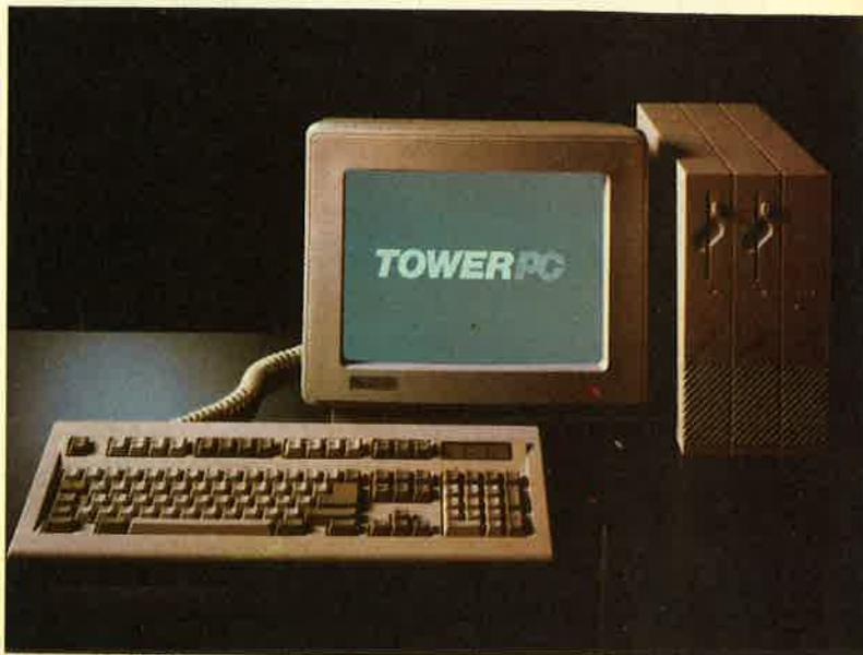
Der 10 MHz getaktete AT wurde mit einem Intel-80286-Prozessor ausgestattet und verfügt über 512 KByte RAM (erweiterbar auf 640 KByte) sowie 32 KByte ROM. Je nach Modell sind neben einem 3,5"-Floppy-Laufwerk (720 KByte) ein zweites Laufwerk und/oder eine 20-MByte-Festplatte eingebaut. Wahlweise kann ein 5 1/4"-Diskettenlaufwerk mit 360 KByte angeschlossen werden.
