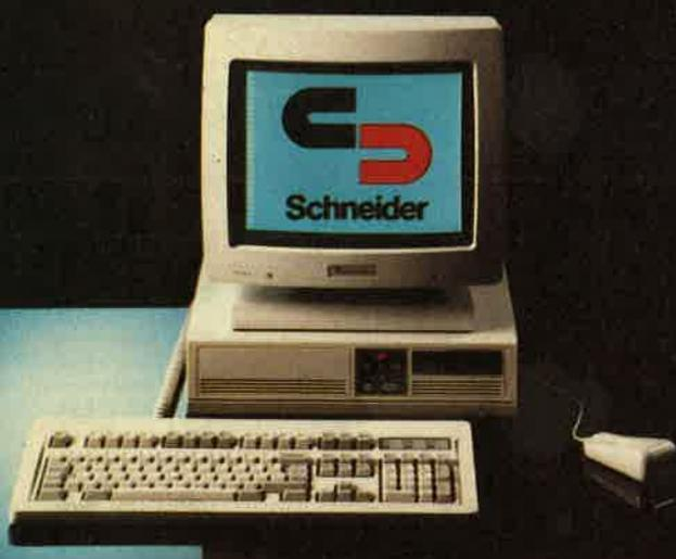
len AT-Standard (102 Tasten). Bei Betätigung gibt die Tastatur nicht nach; sie ist mit "Fingeransatzpunkten" auf F, J und 5 versehen. Die Stellung der Toogle-Tasten (NUM-, SHIFT- und SCROLL-LOCK) wird über LEDs angezeigt. Die Tastatur ist mit 48 cm breiter als die Zentraleinheit.
