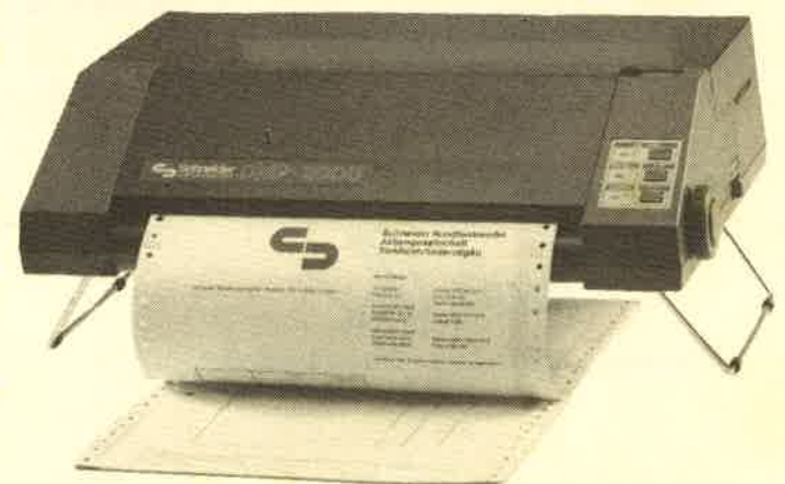
Der neue Schneider Matrix-Drucker DMP 2000. Er arbeitet nach dem Flachbett-Prinzip.
