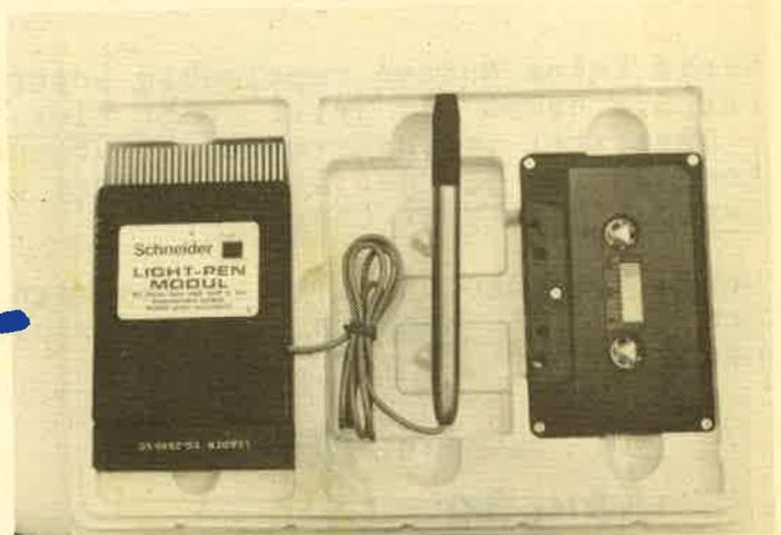
Der Lindy-Lightpen in einer stabilen Kunststoffhülle mit deutscher Anleitung, einer Softwarekassette, dem Interface und einem Schraubendreher.
