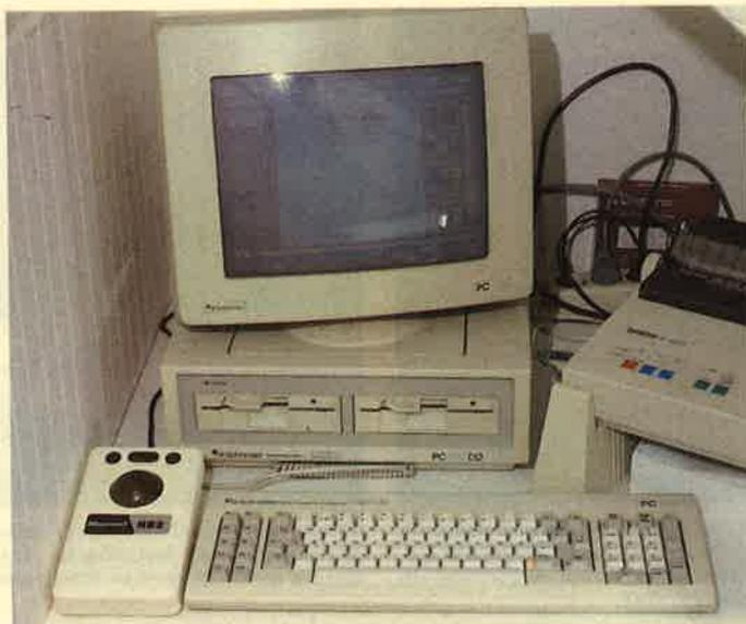
Wenn's der Maus zu eng wird, hilft der Trackball weiter. Die Bewegung der Kugel ersetzt das Herumfahren mit der Maus.
